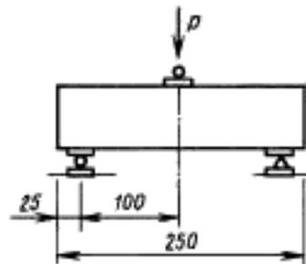
3.3.1. Предел прочности при изгибе  $R_{изг}$ , МПа (кгс/см<sup>2</sup>), образца вычисляют по формуле
