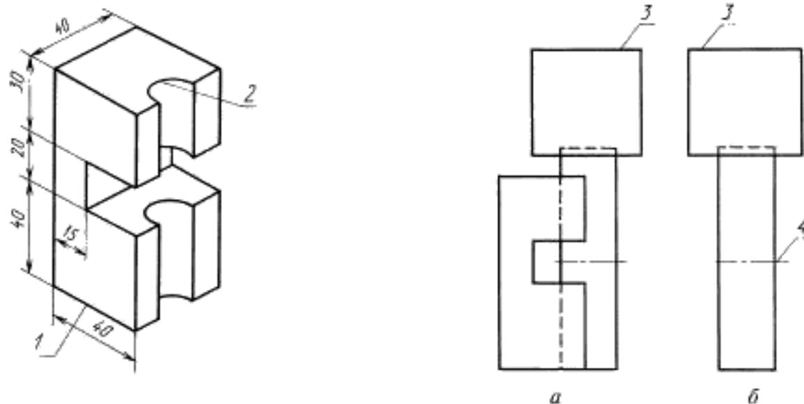
1 — зажимное устройство; 2 — полукружность для обеспечения плотного прилегания цилиндра
