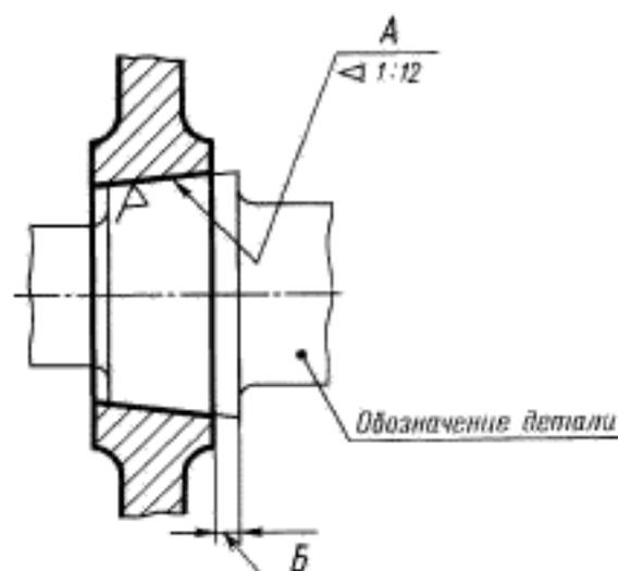
1. Поверхн. А обработать по дет. . . , выдержав размер Б.
