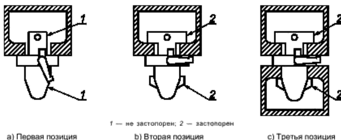
Рисунок В.2 — Полуавтоматический стопор, установленный в нижний угловой фитинг
