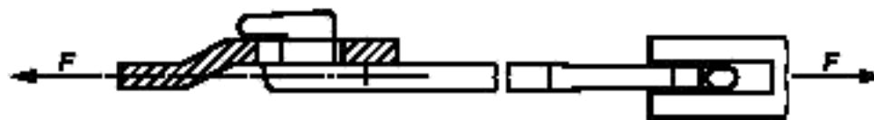
Рисунок D.8 — Испытание контейнерной штанги на растяжение
