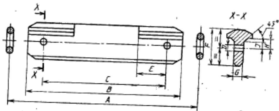
Рисунок 1 — Размеры Т-образных скребков
