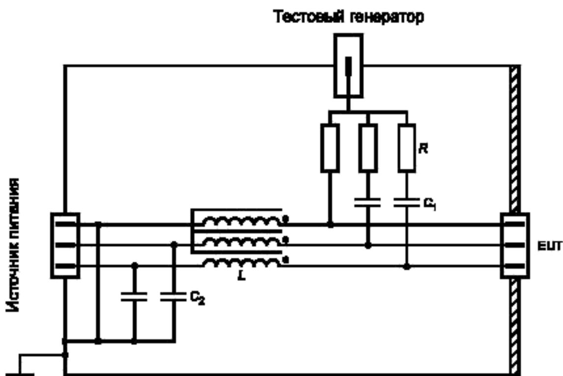
Примечание — CDN = M3, C<sub>1</sub> (typ) = 10 нФ, C<sub>2</sub> (typ) = 47 нФ, R = 300 Ом, L ≥ 280 мкГн для 150 кГц; CDN = M2, C<sub>1</sub> (typ) = 10 нФ, C<sub>2</sub> (typ) = 47 нФ, R = 200 Ом, L ≥ 280 мкГн для 150 кГц; CDN = M1, C<sub>1</sub> (typ) = 22 нФ, C<sub>2</sub> (typ) = 47 нФ, R = 100 Ом, L ≥ 280 мкГн для 150 кГц.
