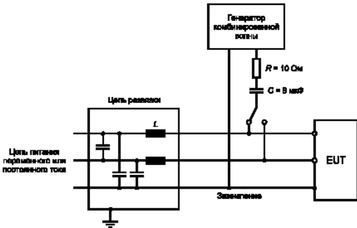
б) Пример испытательной схемы ёмкостной связи линий переменного или постоянного тока; линия-земля, генератора с заземленным выходом
