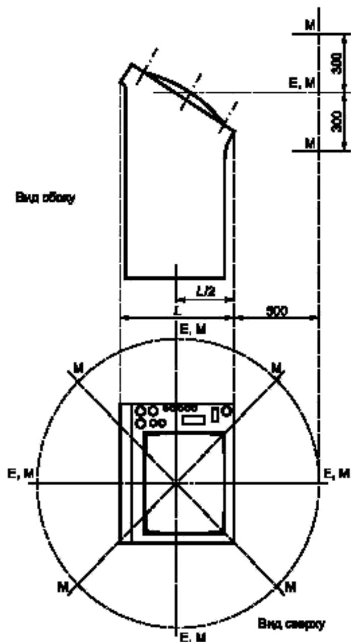
М — положение для измерения магнитного поля; Е — положение для измерения электрического поля
