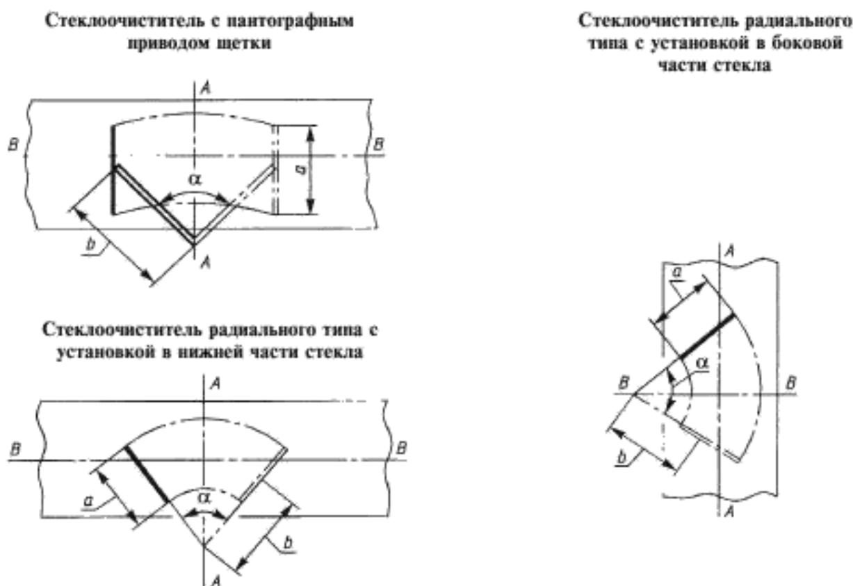
$a$  — длина щетки;  $b$  — длина рычага (пантографного устройства);  $\alpha$  — угол размаха щетки стеклоочистителя;
