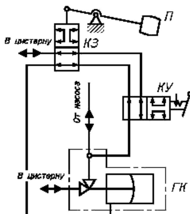
ГК — гидроклапан; П — поплавок; КЗ — клапан золотниковый; КУ — клапан управления
