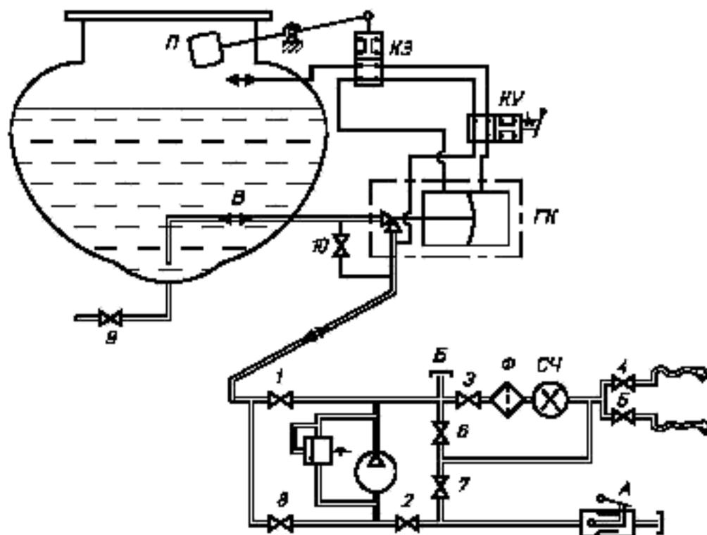
1—9 — задвижки; 10 — вентиль; А — напорно-всасывающий патрубок; Б — напорный патрубок; В — трубопровод для наполнения и опорожнения; ГК — гидроклапан; П — поплавок; КЗ — клапан золотниковый; КУ — кран управления; Ф — фильтр; СЧ — счетчик
