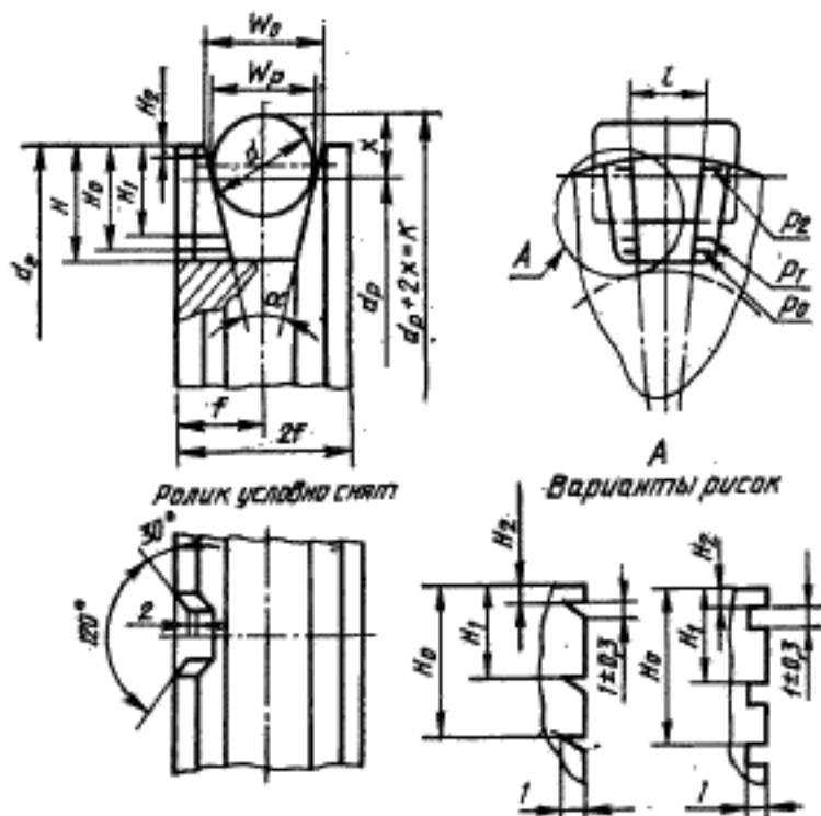
$W_1$  — ширина канавки по наружному диаметру;  $W_p$  — расчетная ширина;  $2f$  — ширина обода шкива;  $\alpha$  — угол канавки шкива;  $d_p$  — расчетный диаметр;  $d_e$  — наружный диаметр шкива;  $d$  — диаметр измерительного ролика;  $H$  — глубина канавки;  $x$  — расстояние от расчетного диаметра шкива до касательной плоскости к ролику, расположенной параллельно оси шкива;  $l$  — ширина паза
