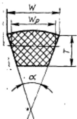
$W$  — ширина большего основания, мм;  $W_p$  — расчетная ширина ремня, мм;  $T$  — высота ремня, мм,  $\alpha$  — угол клюна ремня, град.
