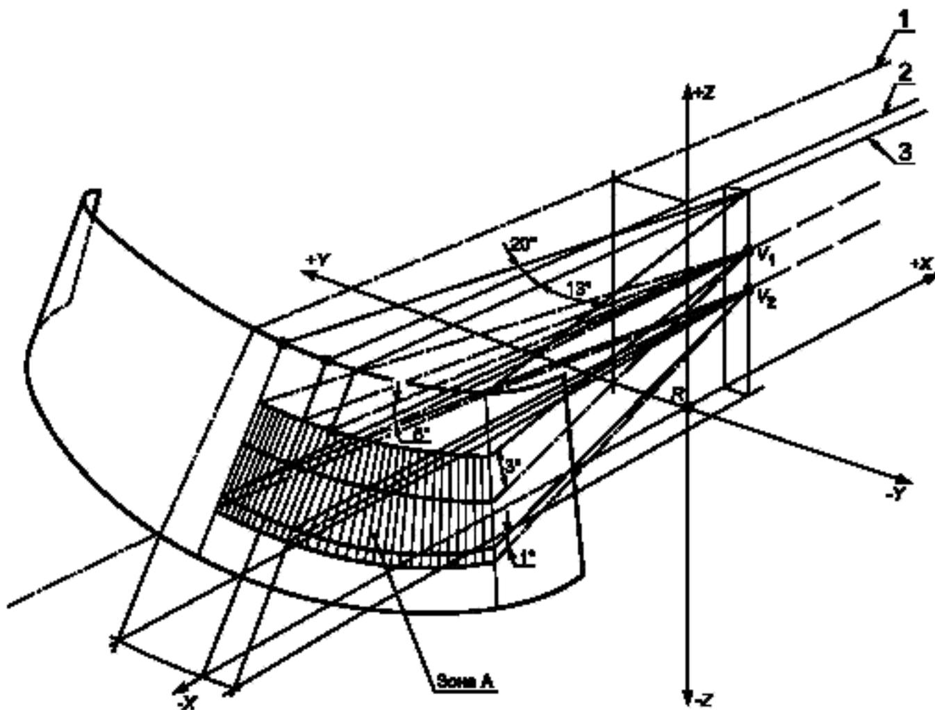
1 — линия, лежащая в средней продольной плоскости транспортного средства; 2 — линия, лежащая в вертикальной продольной плоскости, проходящей через точку  $R$ ; 3 — линия, лежащая в вертикальной продольной плоскости, проходящей через точки  $V_1$  и  $V_2$
