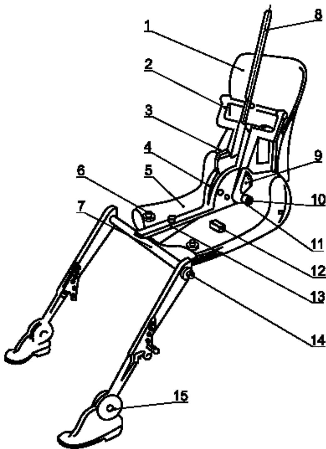
1 — спинка; 2 — кронштейн спинных грузов; 3 — уровень угла наклона спинки; 4 — круговой сектор наклона бедра; 5 — основание; 6 — кронштейн набедренных грузов; 7 — коленный шарнир; 8 — штыры; 9 — круговой сектор наклона спинки; 10 — визирные метки точки *H*, *H'* — ось вращения точки *H*; 11 — поперечный уровень; 12 — кронштейн бедра; 13 — круговой сектор сгиба колена; 14 — круговой сектор сгиба ступни; 15 — круговой сектор сгиба ступни
