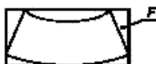
Рисунок 1 — Описание параметра F ветрового стекла (площадь развертки ветрового стекла)
