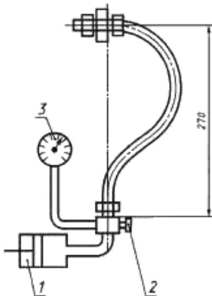
1 — источник давления; 2 — запорный клапан; 3 — манометр
