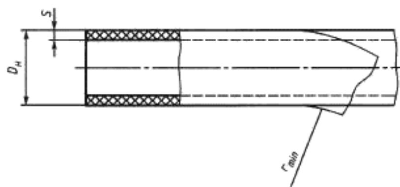
Рисунок 1 — Геометрические параметры труб
