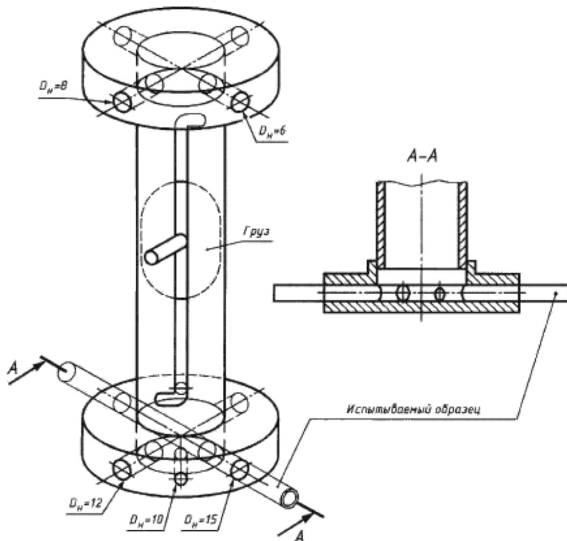
Рисунок 6 — Универсальная установка для испытаний на удар
