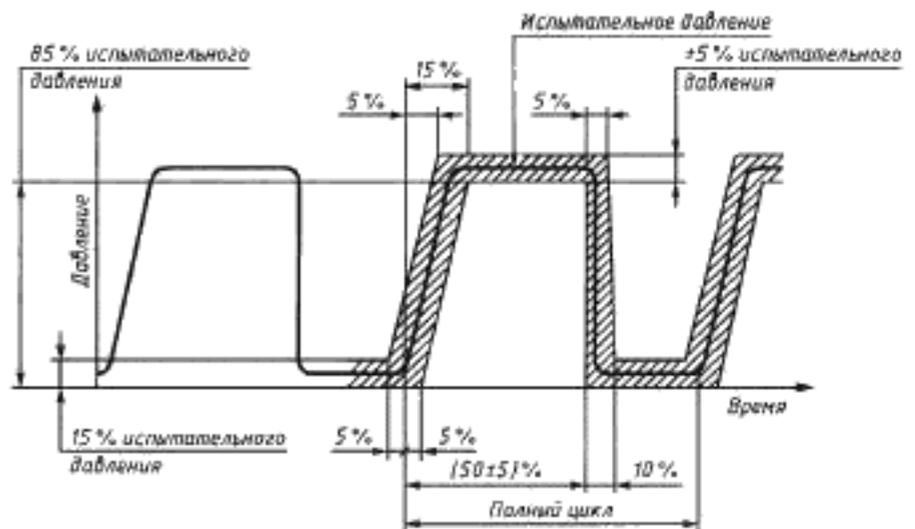
Рисунок 8 — Циклограмма изменения давления в испытываемом трубопроводе
