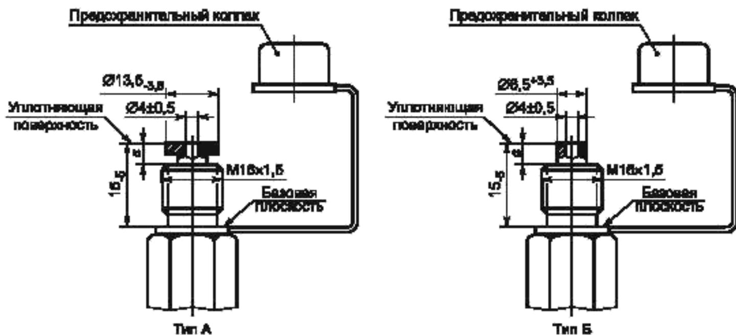
Рисунок А.2 — Присоединительные размеры клапанов контрольного вывода
