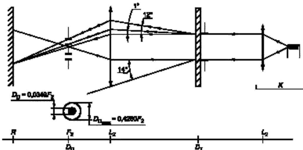
Рисунок 1 — Схема измерения коэффициента рассеивания и пропускания света
