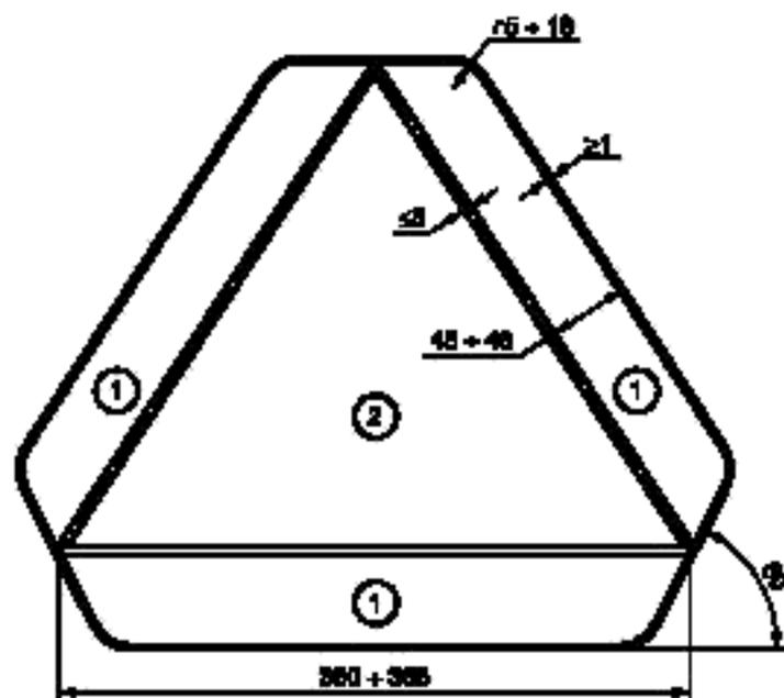
1 — красный светоотражающий материал или рельефный светоотражатель (класс 1 или класс 2);
