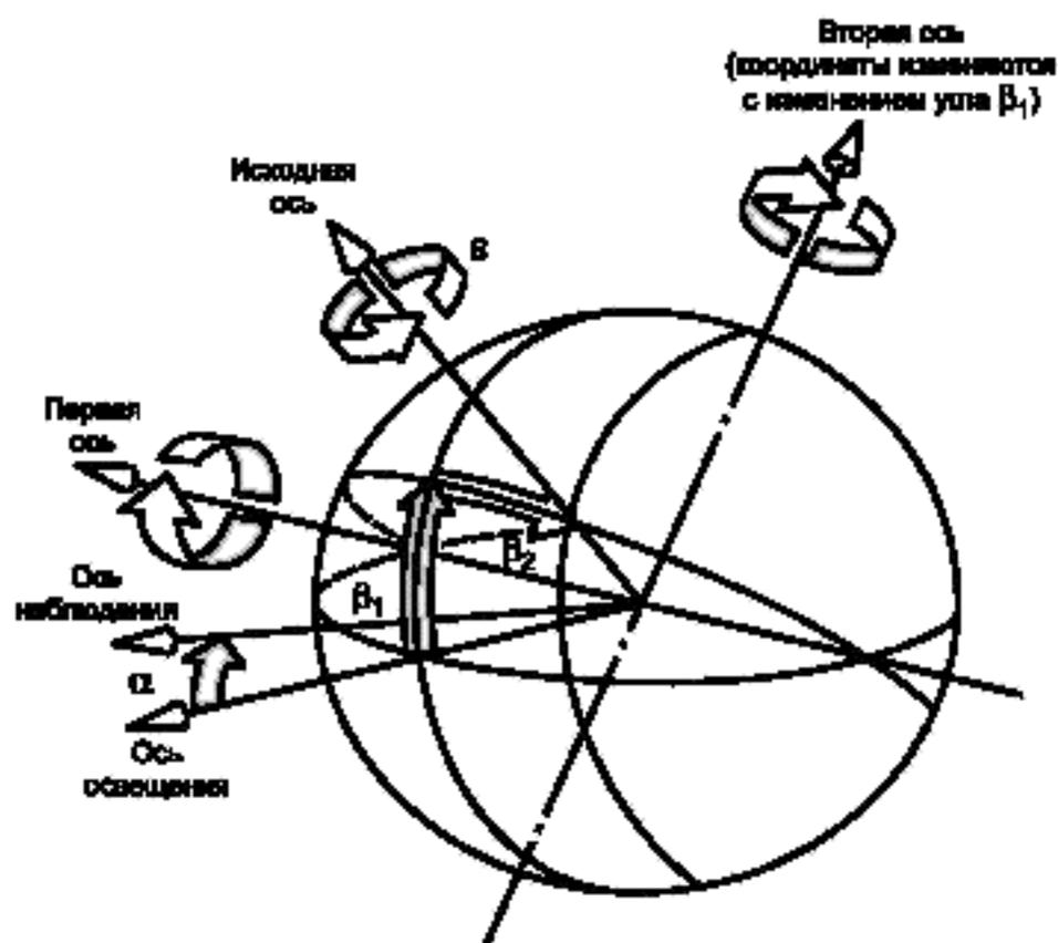
Система углов МКО для определения и измерения светоотражения. Первая ось перпендикулярна к плоскости, в которой проходят ось наблюдения и ось освещения. Вторая ось перпендикулярна как первой оси, так и исходной оси. Все оси, углы и направления вращения показаны положительными.
