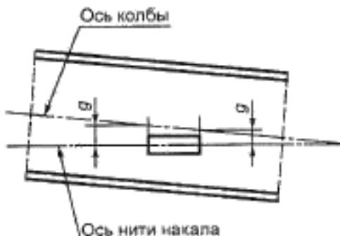
Рисунок 6 — Эксцентризитет оси колбы <sup>8)</sup>
