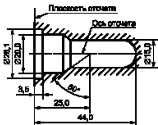
Рисунок 2 — Максимальные размеры лампы <sup>1)</sup>
