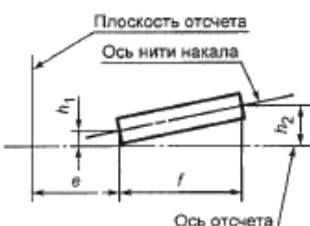
Рисунок 5 — Допустимое смещение оси нити накала<sup>4)</sup> (только для эталонных ламп накаливания)
