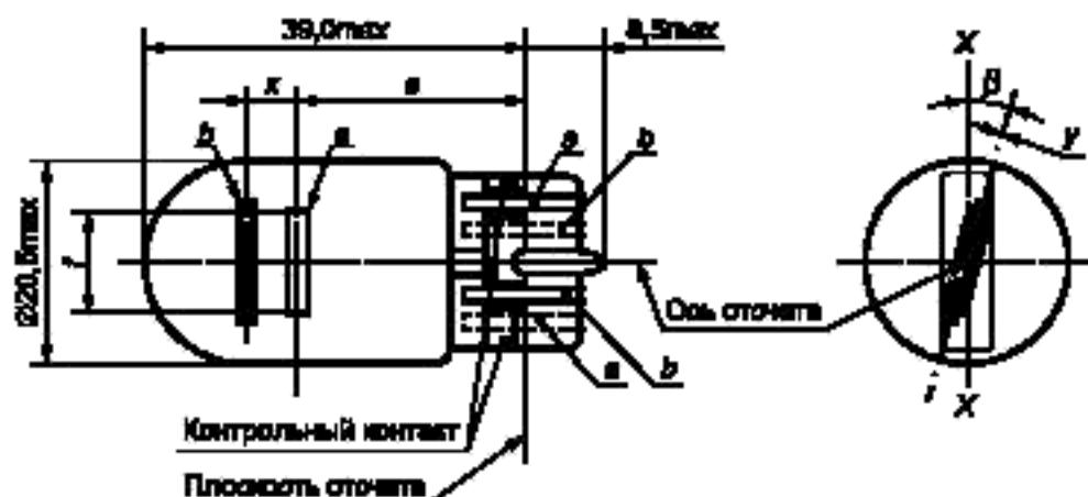
*a* — основная (с высокой номинальной мощностью) нить накала; *b* — вспомогательная (с низкой номинальной мощностью) нить накала
