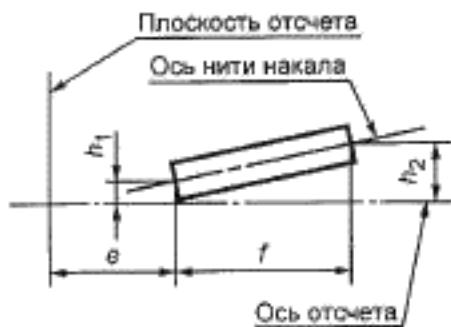
Рисунок 5 — Смещение нити накала <sup>7)</sup> (только для эталонных ламп накаливания)
