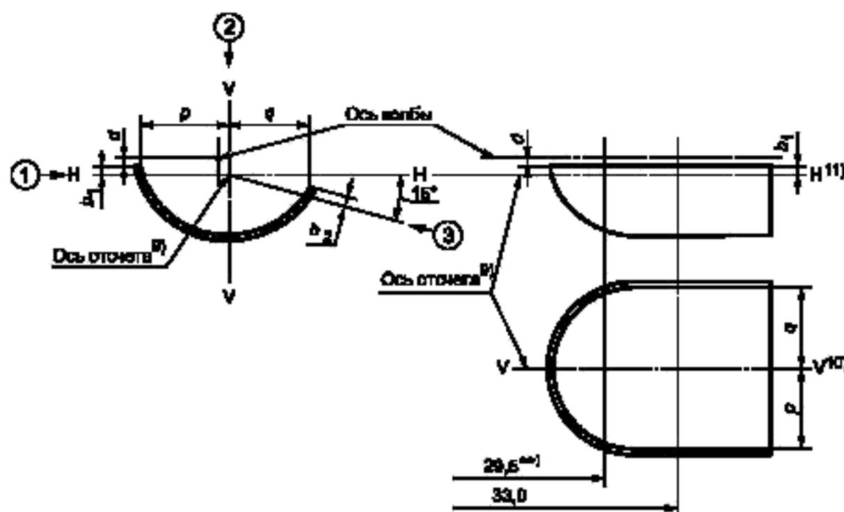
Расположение нитей накала<sup>\*\*</sup>
