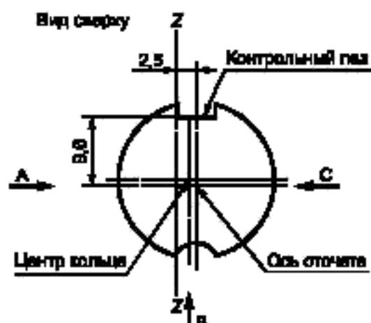
**Определение линии Z-Z**
