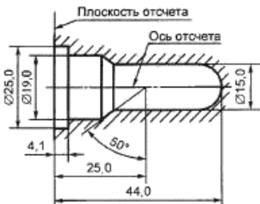
Рисунок 2 — Максимальные размеры лампы <sup>1)</sup>
