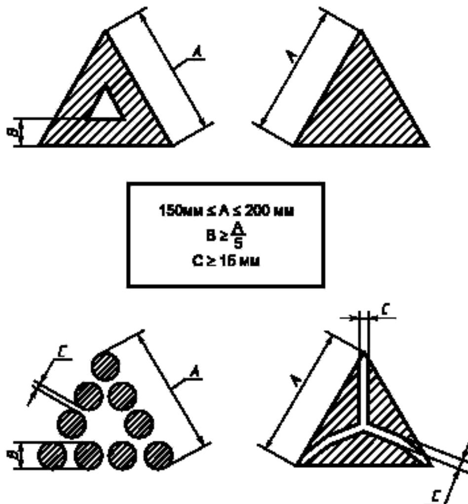
Рисунок 1 — Отражатели света для прицепов класса III A
