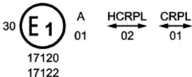
Приведенный выше пример соответствует маркировке рассеивателя из пластического материала, предназначенного для использования с несколькими типами фар, а именно:
