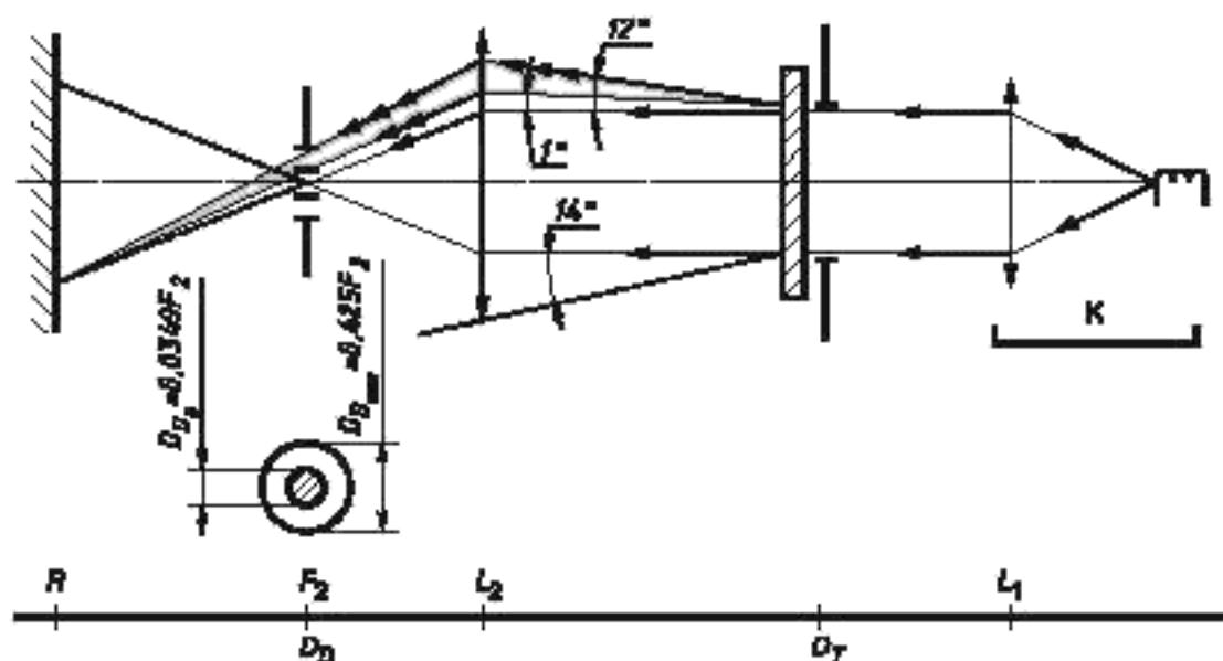
Луч коллиматора К с половинчатым отклонением  $\frac{\beta}{2} = 17.4 \times 10^{-4}$  рад ограничен диафрагмой  $D_1$ , с отверстием 6 мм, перед которым помещают подставку с образцом.
