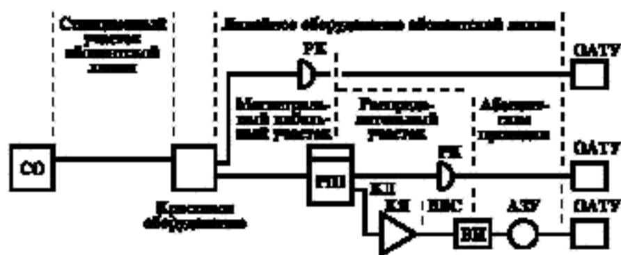
СО — станционное оборудование; ВЛС — воздушная линия связи; КЛ — кабельная линия; РШ — кабельный распределительный шкаф; РК — абонентская распределительная коробка; КЯ — телефонный кабельный ящик; ВИ — вводные изоляторы; АЗУ — абонентское защитное устройство; ОАТУ — окончательное оборудование; — место стыка
