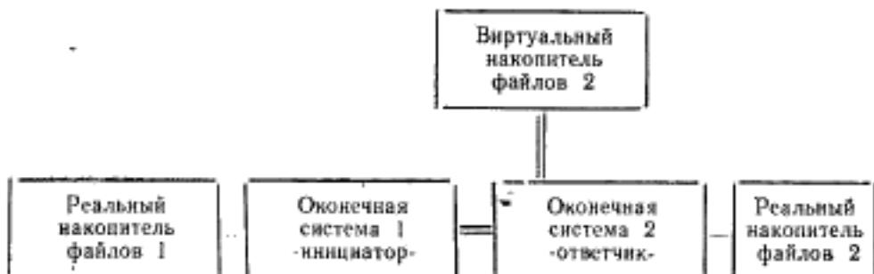
Рисунок 1 — Доступ к файлам между двумя оконечными системами
