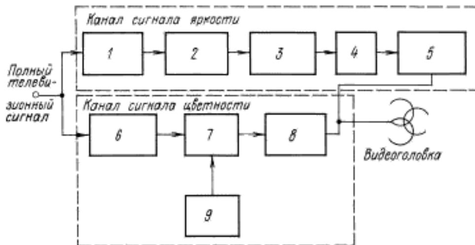
1, 8 — фильтры нижних частот; 2 — схема частотных предыскажений; 3 — частотный модулятор; 4 — фильтр верхних частот; 5 — усилитель записи; 6 — полосовой фильтр; 7 — преобразователь частоты; 9 — гетеродин
