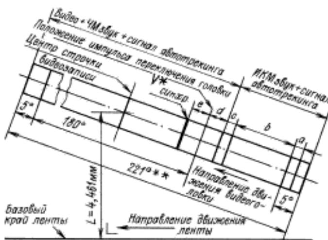
\*  $V_{\text{синхр}}$  — положение кадрового синхроимпульса.
