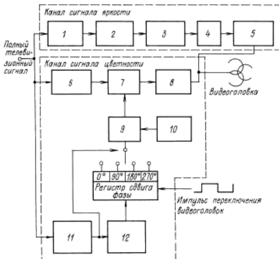
1, 8 — фильтры низких частот; 2 — схема частотных предискажений; 3 — частотный модулятор;
