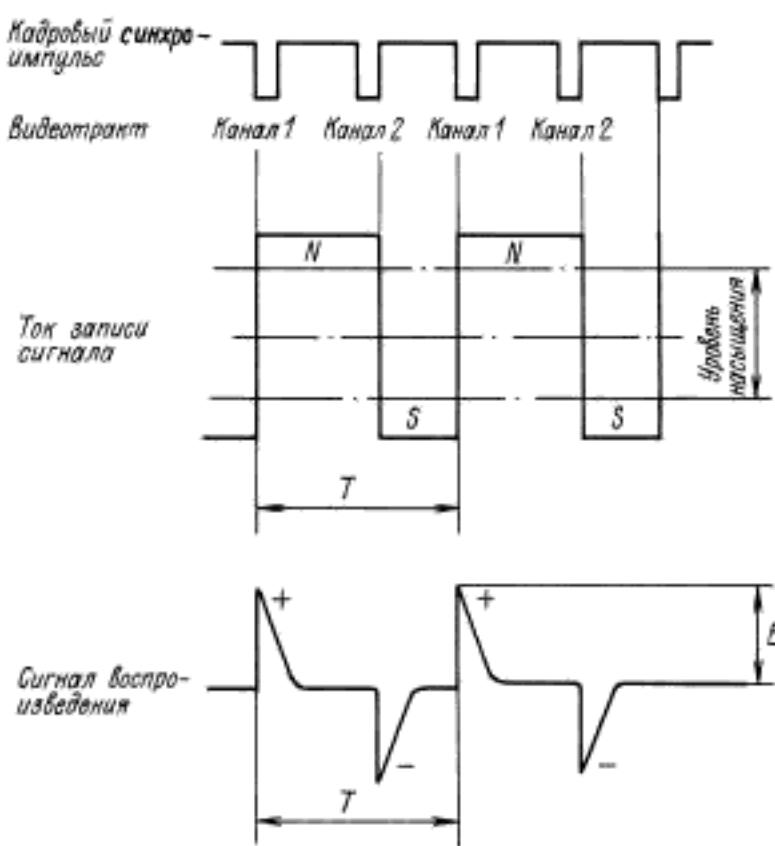
2.6.3. При положительном импульсе сигнала управления полюс головки канала управления, ближайший к барабану видеомагнитофона, должен иметь северную поляризацию.
