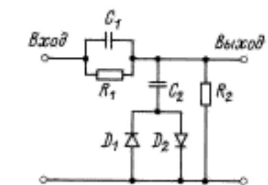
$U = 4,0 \text{ В}$ ;  $T = C_1 = C_2 = 0,8 \text{ мкс}$ ;  $X = R_1/R_2 = 3$  (при минус 20 дБ);  $D_1, D_2$  — диоды Шоттки
