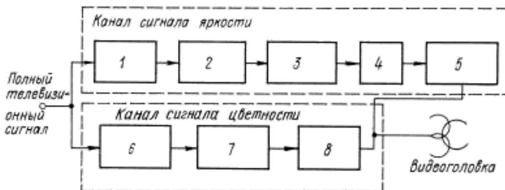
1, 8 — фильтры нижних частот; 2 — схема частотных предыскажений; 3 — частотный модулятор; 4 — фильтр верхних частот; 5 — усилитель записи; 6 — полосовой фильтр; 7 — делитель частоты на четыре
