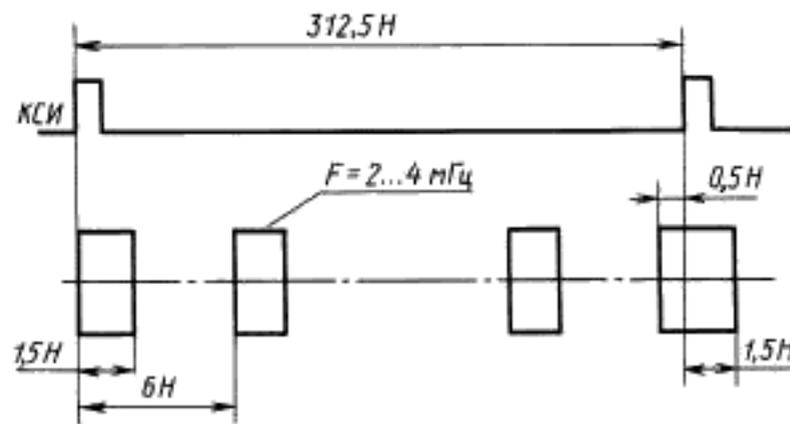
Структура испытательного сигнала И
