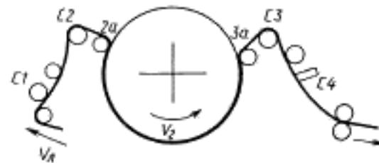
$V_1$  — направление движения ленты;  $V_2$  — направление вращения видеоголовки; 2a, C1, C2 — входные стойки; 3a, C3, C4 — выходные стойки
