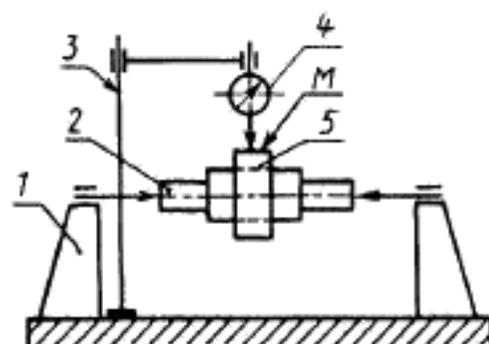
1 — прибор ПБ-500М; 2 — коническая оправка; 3 — стойка прибора;
