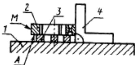
1 — поверочная плита; 2 — сердечник; 3 — опора; 4 — угольник УЛП
