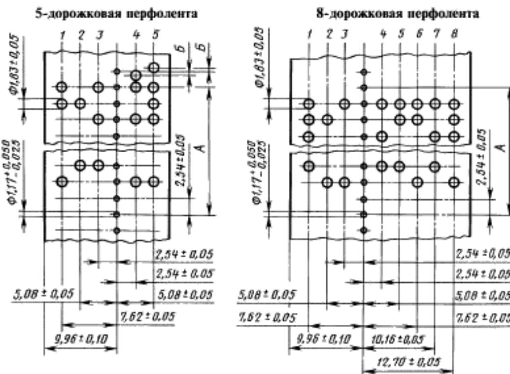
П р и м е ч а н и е. Условная нумерация дорожек, указанная на чертеже, не определяет порядок считывания и воспроизведения данных.
