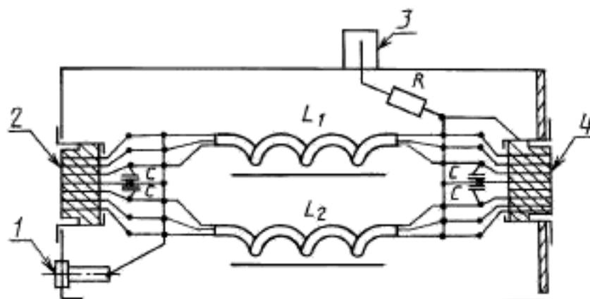
1 — зажим заземления; 2 — разъем подключения полезного сигнала (цепь генератора телевизионных испытательных сигналов); 3 — разъем подключения источника помех (цепь ВЧ генератора); 4 — разъем подключения испытуемого ВМ;  $C = 1 \text{ нФ}$ ;  $L_1 = L_2 = 60 \text{ мкГн}$ ;  $R = 100 \text{ Ом}$
