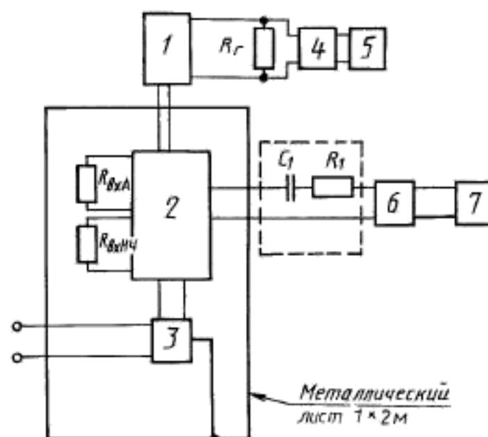
1 — контрольный телевизор; 2 — испытуемый ВМ; 3 — устройство ввода помех типа М; 4 — полосовой фильтр; 5 — милливольтметр; 6 — фильтр высоких частот; 7 — ВЧ генератор
