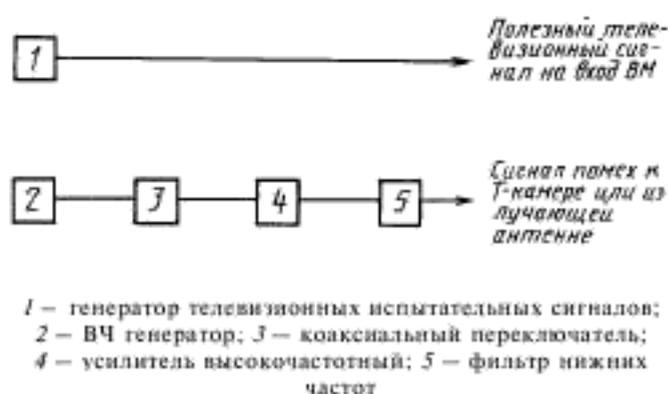
1 — генератор телевизионных испытательных сигналов;
