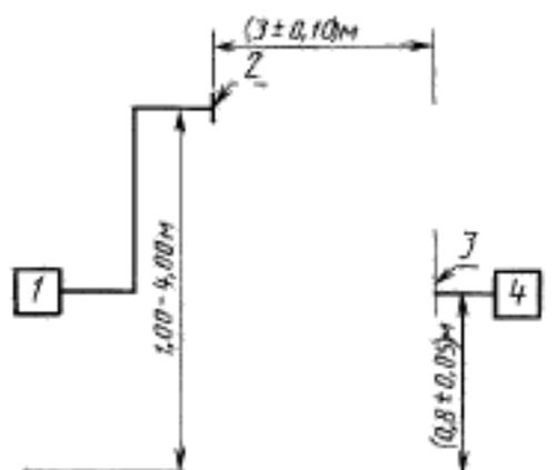
1 — ВЧ генератор; 2 — излучающая антенна; 3 — приемная антенна;
