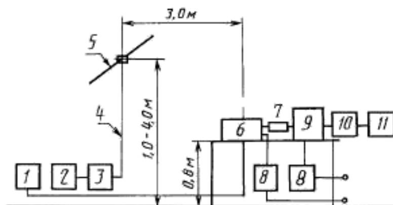
1 — генератор телевизионного испытательного сигнала; 2 — ВЧ генератор; 3 — усилитель высокочастотный; 4 — коаксиальный кабель; 5 — дипольная излучающая антенна; 6 — испытуемый ВМ; 7 — ферритовые кольца; 8 — устройство ввода помех типа М; 9 — контрольный телевизор; 10 — полосовой фильтр; 11 — милливольтметр
