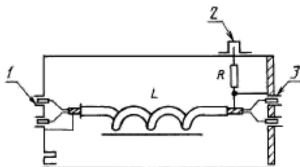
1 — разъем подключения входных или выходных звуковых сигналов; 2 — разъем подключения источника помех (цепь ВЧ генератора); 3 — разъем подключения испытуемого ВМ;  $L = 30 \text{ мкГн}$ ;  $R = 100 \text{ Ом}$
