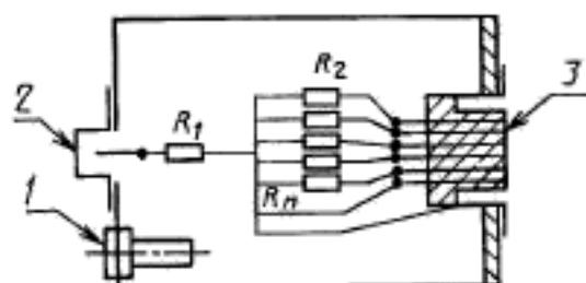
1 — зажим заземления; 2 — разъем подключения источника помех (цепь ВЧ генератора); 3 — разъем подключения испытуемого ВМ;  $R_1 = 100 \text{ Ом}$ ;  $R_2 \dots R_n$  составляют:  $2 \times 2,2 \text{ кОм}$  — для магнитного звукоснимателя;  $2 \times 470 \text{ кОм}$  — для кристаллического звукоснимателя;  $2 \times 47 \text{ кОм}$  — для пюнера;  $4 \times 47 \text{ кОм}$  — для звуковой вх/вых
