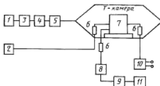
1 — ВЧ генератор; 2 — генератор телевизионных испытательных сигналов; 3 — коаксиальный переключатель; 4 — усилитель высокочастотный; 5 — фильтр нижних частот; 6 — ферритовые кольца; 7 — испытуемый ВМ; 8 — контрольный телевизор; 9 — фильтр полосовой; 10 — сетевой фильтр; 11 — милливольтметр
