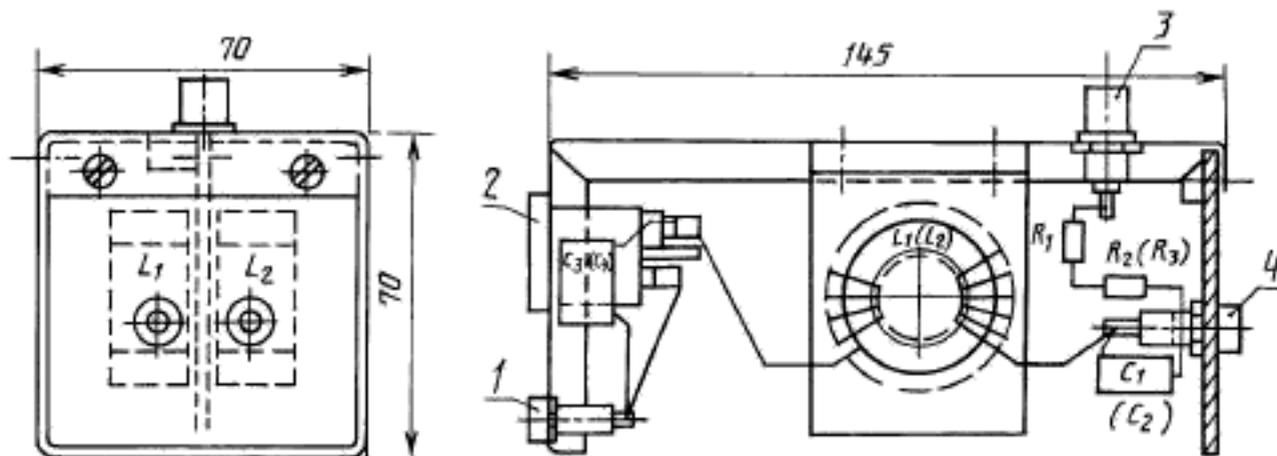
1 — зажим заземления; 2 — сеть питания; 3 — разъем подключения источника помех (ВЧ генератора); 4 — разъем подключения испытываемого ВМ;  $R_1 = 62$  Ом;  $R_2 = R_3 = 75$  Ом;  $C_1 = C_2 = 10$  нФ;  $C_3 = C_4 = 47$  нФ;  $L_1 = L_2 = 60$  мкГн
