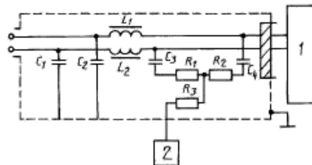
1 — испытываемый ВМ; 2 — ВЧ генератор;  $L_1 = L_2 = 60$  мкГн;
