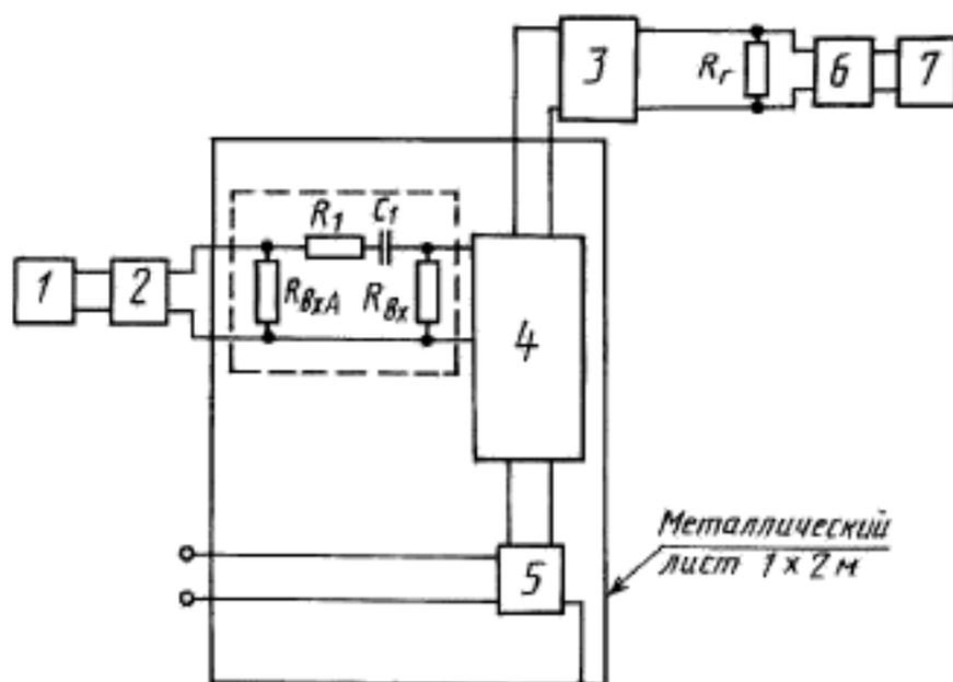
1 — ВЧ генератор; 2 — фильтр нижних частот; 3 — контрольный телевизор; 4 — испытываемый ВМ; 5 — устройство ввода помех типа М; 6 — полосовой фильтр; 7 — милливольтметр;  $R_1 = 750$  Ом;  $C_f = 470$  пФ;  $R_{вх} = 47$  кОм;  $R_{вхА} = 75$  Ом;  $R_i = 8$  Ом
