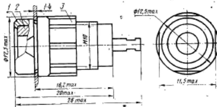
1—корпус; 2—втулка; 3—гайка
