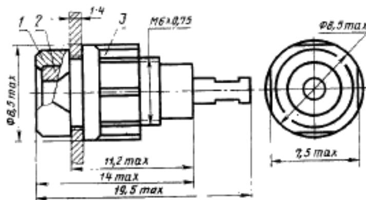
1—корпус; 2—втулка; 3—гайка
