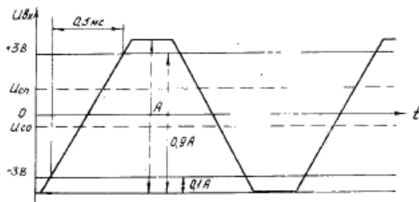
$U_{\text{вх}}$  — напряжение сигнала на входе ТГА, АПД;  $U_{\text{с.п}}$ ,  $U_{\text{с.0}}$  — напряжение срабатывания входного устройства для положительной и отрицательной полярностей сигнала;  $A$  — удвоенная амплитуда сигнала
