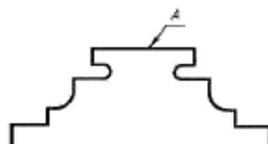
1.9. Если необходимо нанести покрытие на поверхность сложной конфигурации или на часть поверхности, которую нельзя однозначно определить, то такие поверхности обводят штрихпунктирной утолщенной линией на расстоянии 0,8 ... 1 мм от контурной линии, обозначают их одной буквой и проставляют размеры, определяющие положение этих поверхностей; запись делают по типу: «Покрытие поверхности А...» (черт. 4).
