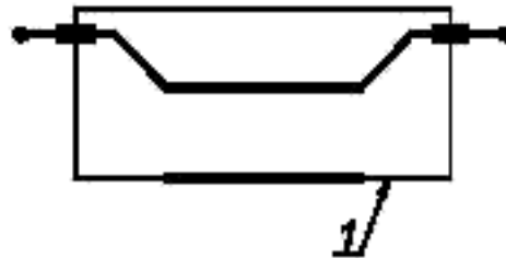
Рисунок 4а — Проходной конденсатор для симметричного включения в цепь (некоаксиальный)
