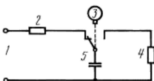
1 — источник питания; 2 — зарядный резистор; 3 — выключатель с мотором; 4 — разрядный резистор; 5 — испытуемый конденсатор
