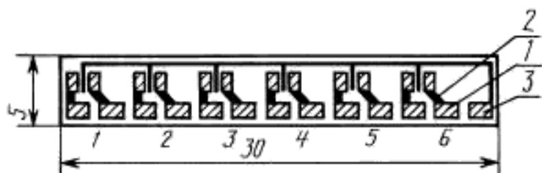
1 — паяемые площадки; 2 — площадки, не подлежащие пайке (покрыты непаяемым лаком); 3 — проводник может быть исключен или использован в качестве защитного электрода
