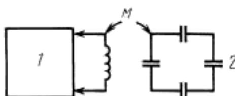
1 — абсорбционный генератор-вольномер (индикатор в цепи сетки); 2 — резонансная схема связи
