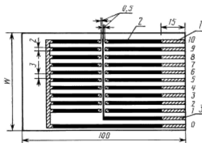
1 — паяемые площадки; 2 — площадки, не подлежащие пайке (покрыты непаяемым лаком); 3 — проводник может быть исключен или использован в качестве защитного электрода;  $W$  — размер, зависящий от конструкции испытательной аппаратуры
