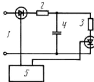
1 — источник питания; 2 — зарядный резистор; 3 — разрядный резистор; 4 — испытуемый конденсатор; 5 — тиристорная цепь зажигания
