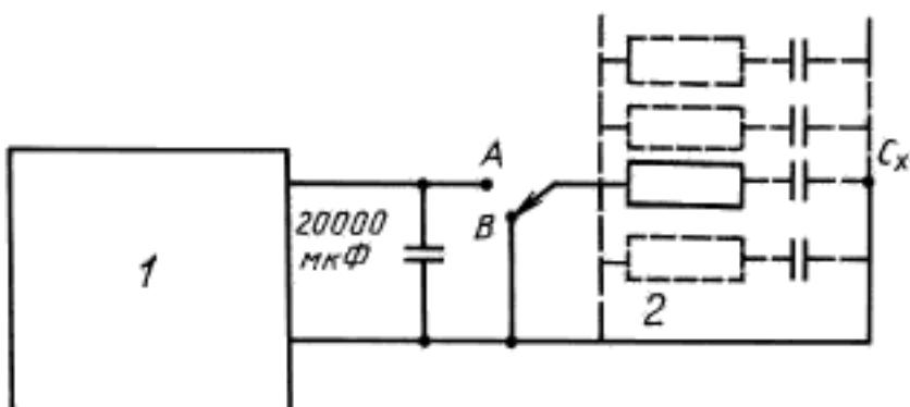
1 — источник постоянного тока; 2 — предохранитель
