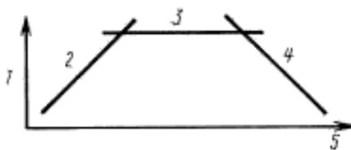
1 — реактивная мощность; 2 — ограничение напряжением; 3 — ограничение реактивной мощностью; 4 — ограничение током; 5 — частота
