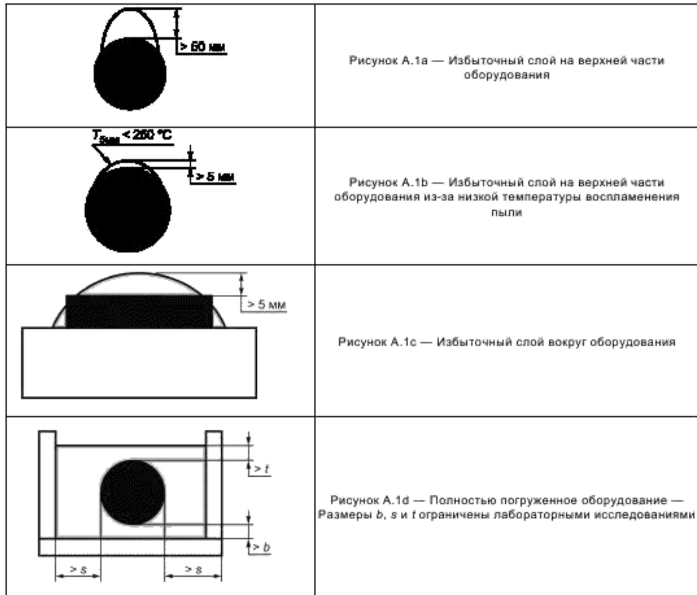
Рисунок А.1 — Примеры слоев пыли избыточной толщины в соответствии с лабораторным исследованием
