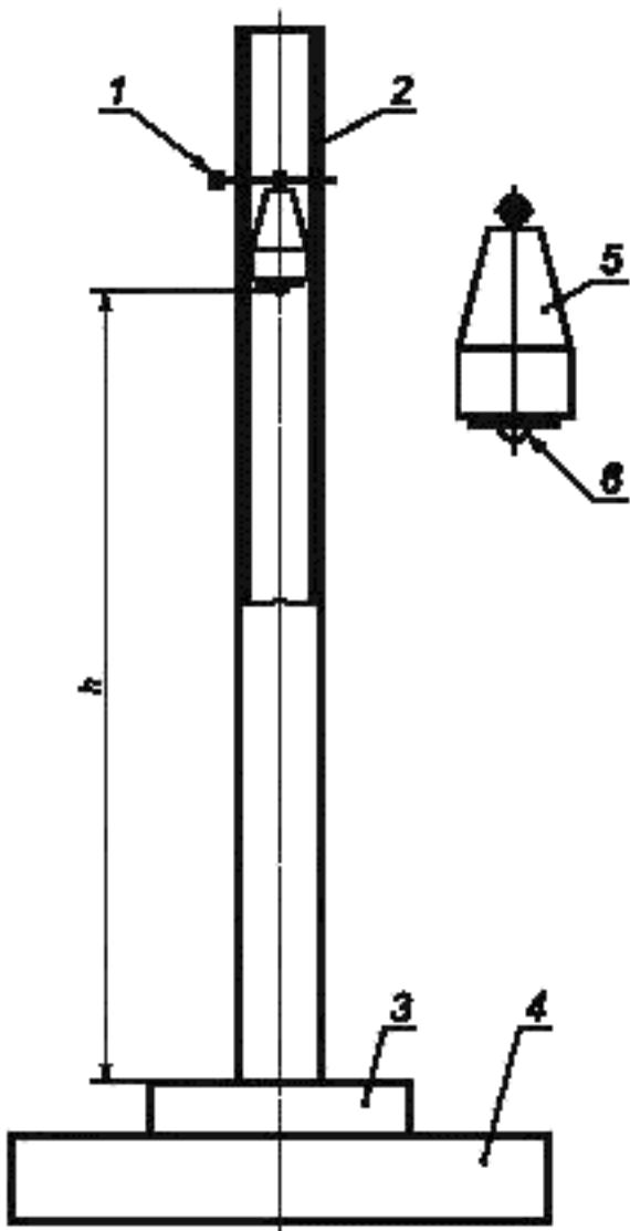
1 — регулировочный штифт; 2 — пластмассовая направляющая труба; 3 — испытуемый образец; 4 — стальная основа (масса > 20 кг); 5 — стальной груз массой 1 кг; 6 — ударная головка диаметром 25 мм из закаленной стали; h — высота падения
