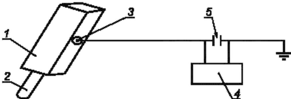
1 — корпус с накопленным зарядом; 2 — тefлоновая ручка; 3 — сферический электрод радиусом 10—15 мм; 4 — вольтметр; 5 — конденсатор емкостью 0,1 мкФ
