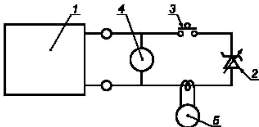
1 — испытуемая цепь; 2 — нагрузка; 3 — ртутный выключатель; 4 — вольтметр высокого сопротивления;
