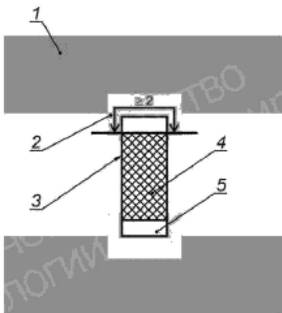
1 — дорожка печатной платы; 2 — паяное сопряжение между подложкой платы и подложкой компонента ( $\geq 2$  мм); 3 — компонент с неповреждаемым соединением; 4 — подложка для пайки компонента; 5 — размер подложки для пайки печатной платы установлен по данным изготовителя
