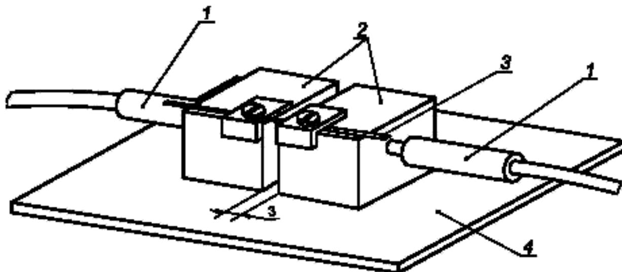
1 — подвод питания; 2 — медный бруск; 3 — вольфрамовая проволочка; 4 — изолирующая пластина
