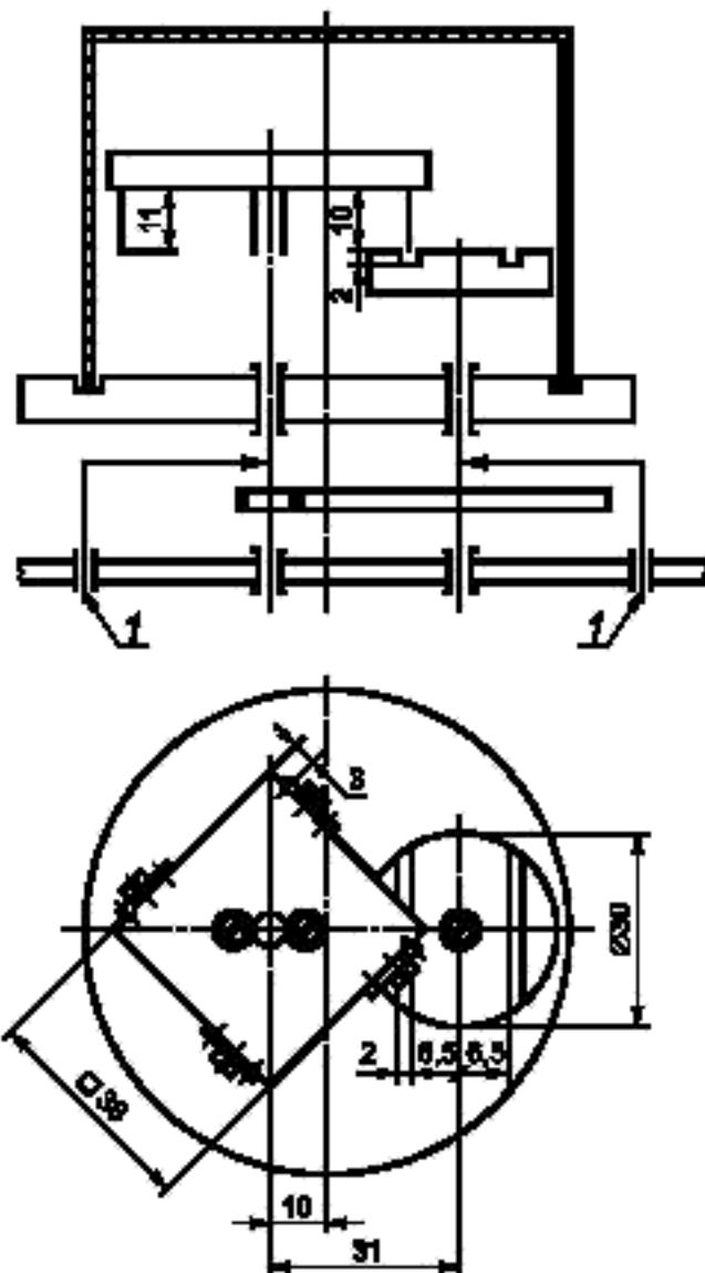
1 — выводы для подключения испытуемой цепи
