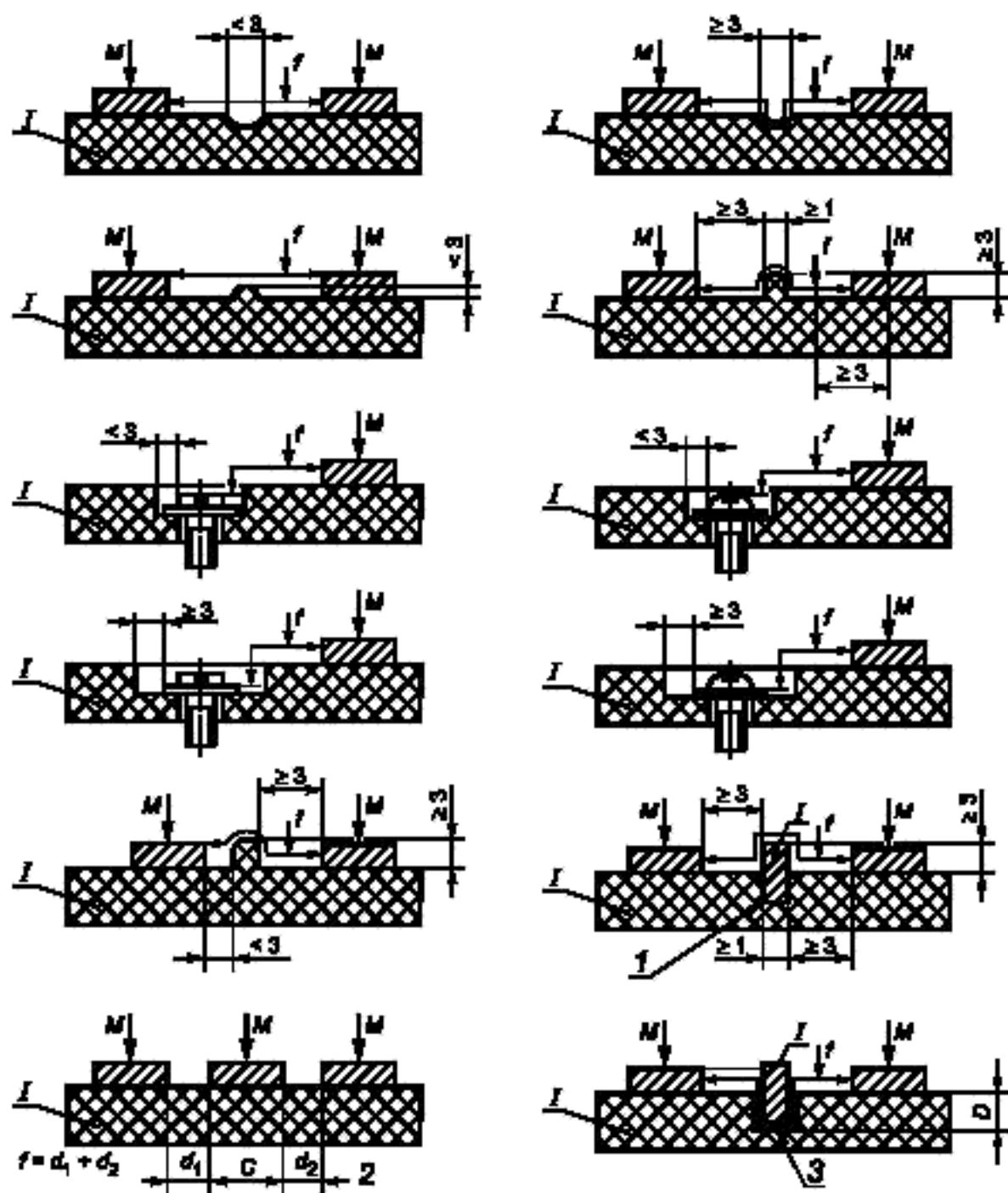
$f$  — длина пути утечки;  $M$  — металл;  $I$  — изоляционный материал;  $t$  — приклеенная перегородка; 2 — центральная металлическая часть: не подключена к источнику напряжения; 3 — неприклеенная перегородка; высота разделительного углубления больше  $D$ .
