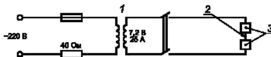
1 — площадь поперечного сечения сердечника  $19 \text{ cm}^2$ ; 2 — вольфрамовая проволочка; 3 — медные бруски
