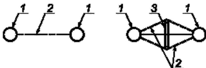
1 — проводник; 2 — зазор; 3 — перегородка
