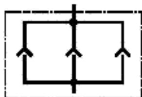
Рисунок 5а — Три независимых соединительных элемента
