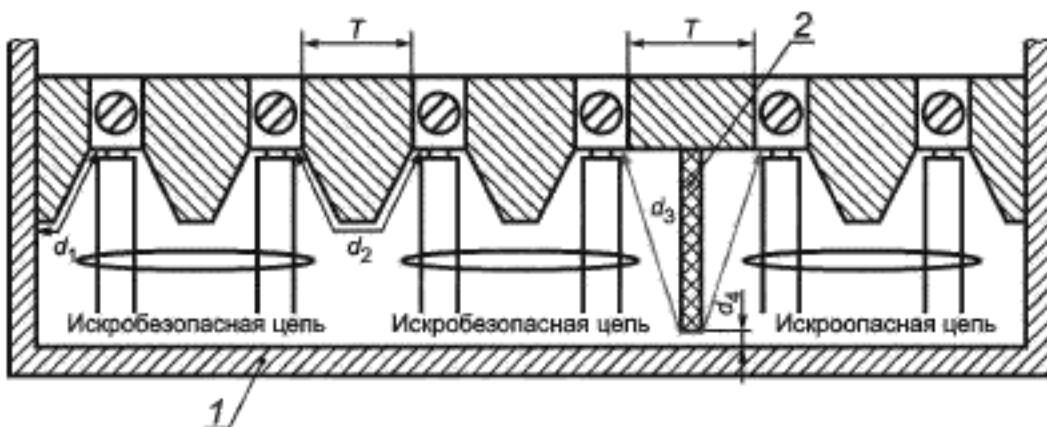
1 — непроводящая или токопроводящая заземленная часть; 2 — перегородка в соответствии с 6.2.1, б).
