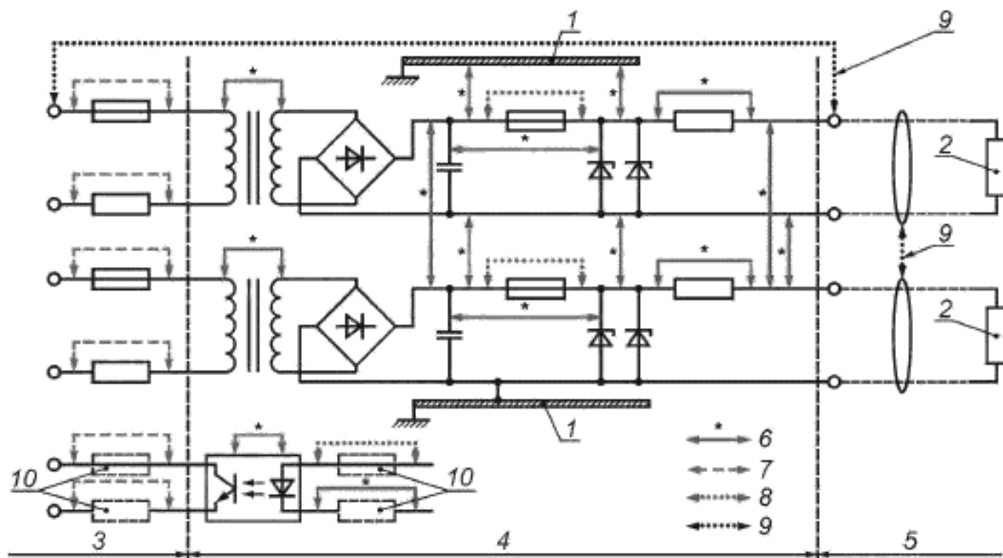
1 — шасси; 2 — нагрузка; 3 — искропасная цепь с  $U_{\text{пр}}$ ; 4 — часть искробезопасной цепи, не являющаяся искробезопасной; 5 — искробезопасная цепь; 6 — размеры, определяемые по таблице 6; 7 — размеры, определяемые по общим промышленным стандартам; 8 — размеры в соответствии с 7.3; 9 — размеры в соответствии с 6.2.1 для выходных зажимов между раздельными искробезопасными цепями и между искробезопасными и искропасными цепями; 10 — если применяются
