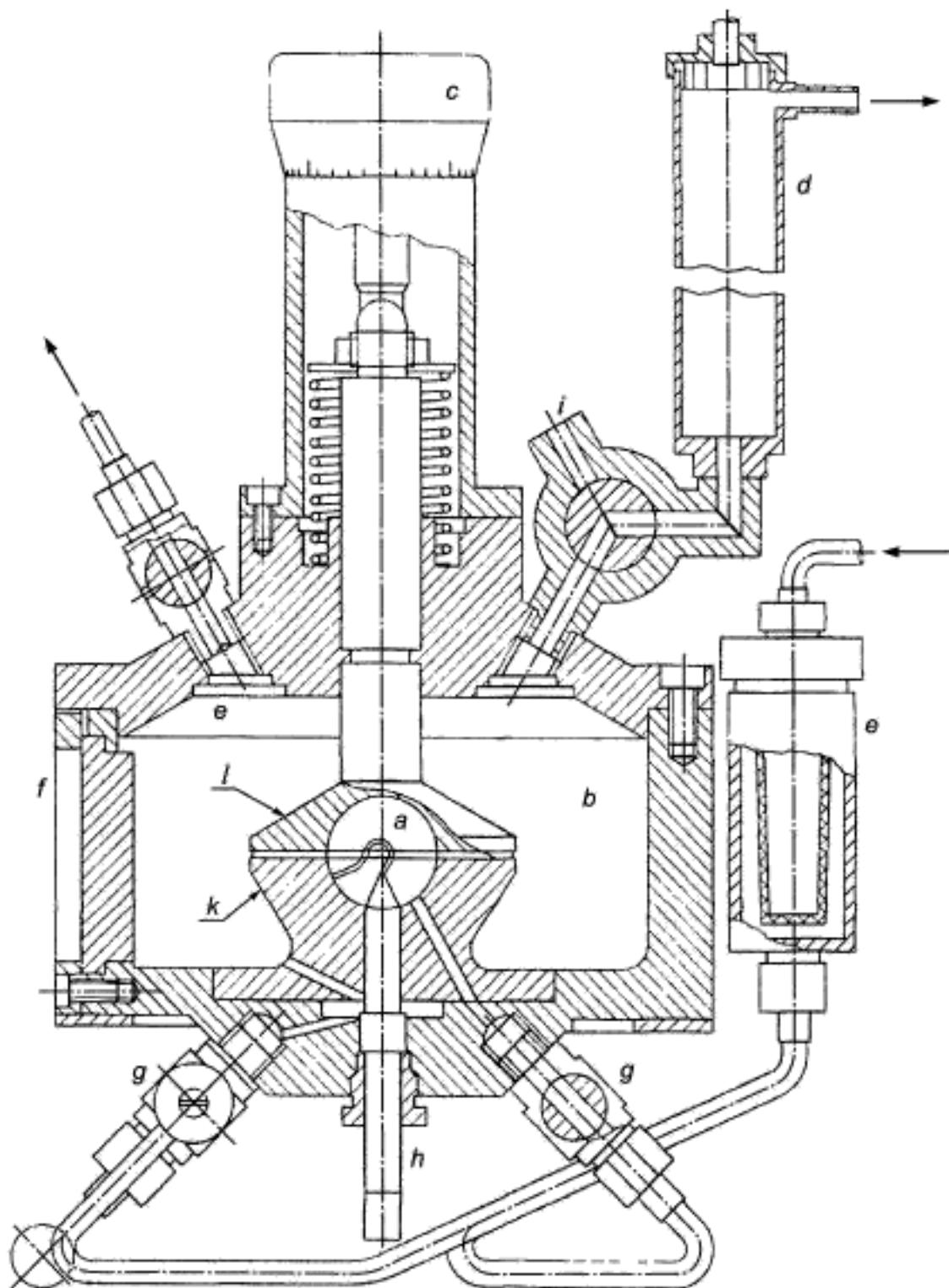
а — внутренняя камера; б — внешняя цилиндрическая оболочка, с — микрометрический винт, д — выходное отверстие;
