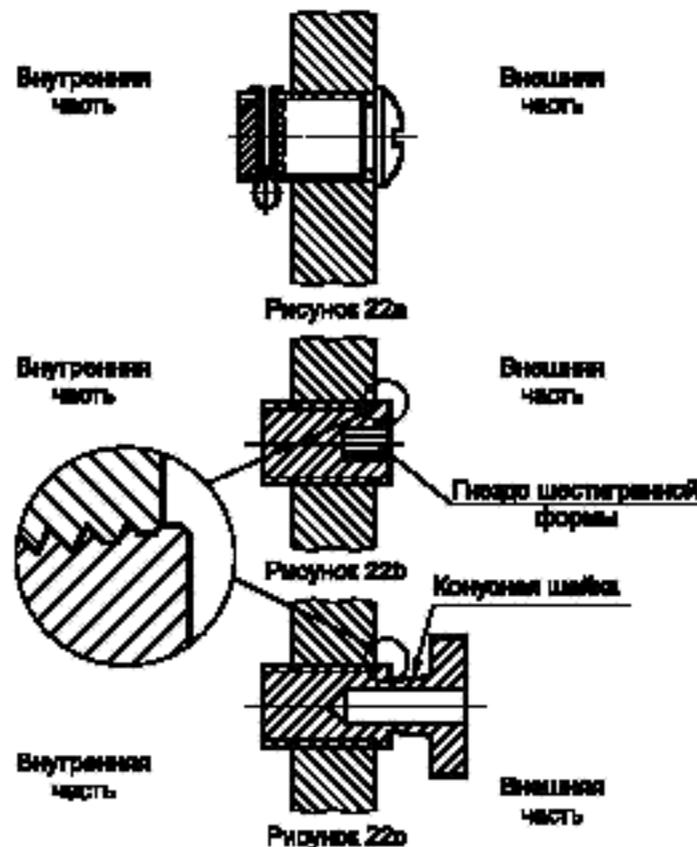
Рисунок 22 — Примеры заглушек для неиспользованных отверстий
