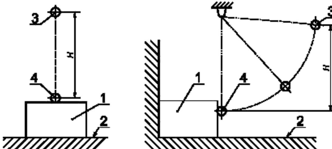
1 — испытуемый образец; 2 — твердая опорная поверхность; 3 — шар в исходном положении;
