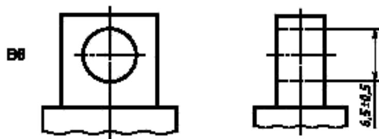
Рисунок 4 — В-контакты (болтовое соединение)
