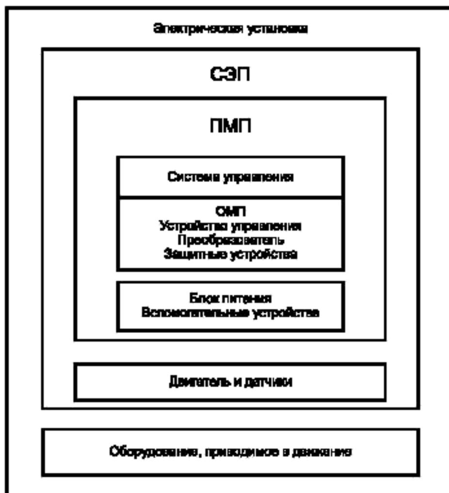
Рисунок 1 — Составные части электрической установки, включающей СЭП
