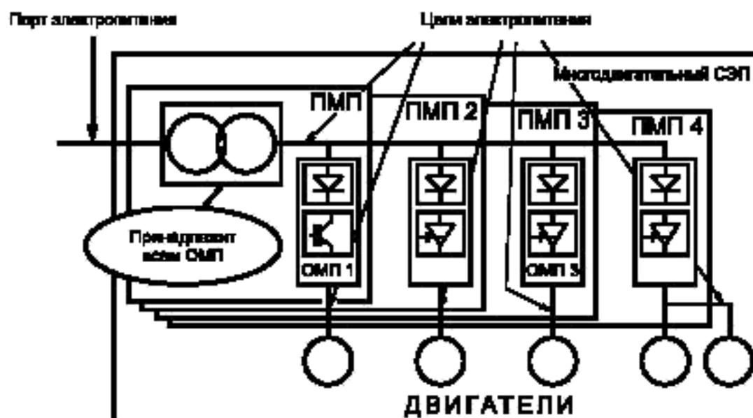
Рисунок 4 — Цепи электропитания СЭП с общим входным трансформатором
