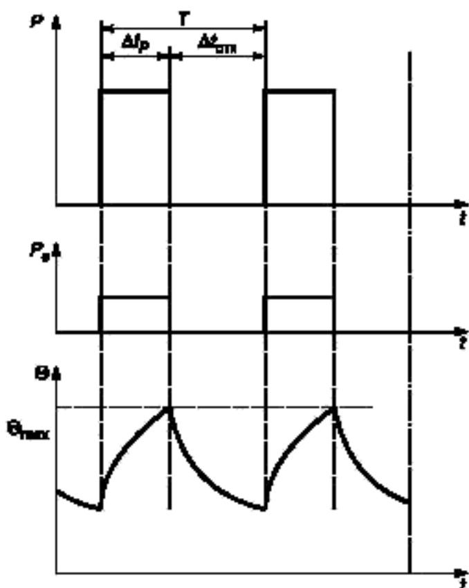
$P$  — нагрузка;  $P_s$  — электрические потери;  $\Theta$  — температура;  $\Theta_{\max}$  — достигнутая максимальная температура;  $t$  — время;  $\Delta t_p$  — время работы с постоянной нагрузкой;  $T$  — время одного цикла нагрузки;  $\Delta t_{on}$  — время остановки или отключения питания машины
