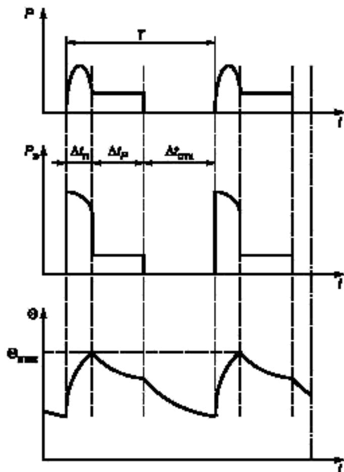
$P$  — нагрузка,  $P_{э}$  — электрические потери,  $\Theta$  — температура;  $\Theta_{\max}$  — достигнутая максимальная температура;  $t$  — время;  $\Delta t_p$  — время работы с постоянной нагрузкой;  $T$  — время одного цикла нагрузки;  $\Delta t_{ост}$  — время остановки или отключения питания машины;  $\Delta t_n$  — время пуска (разгона).
