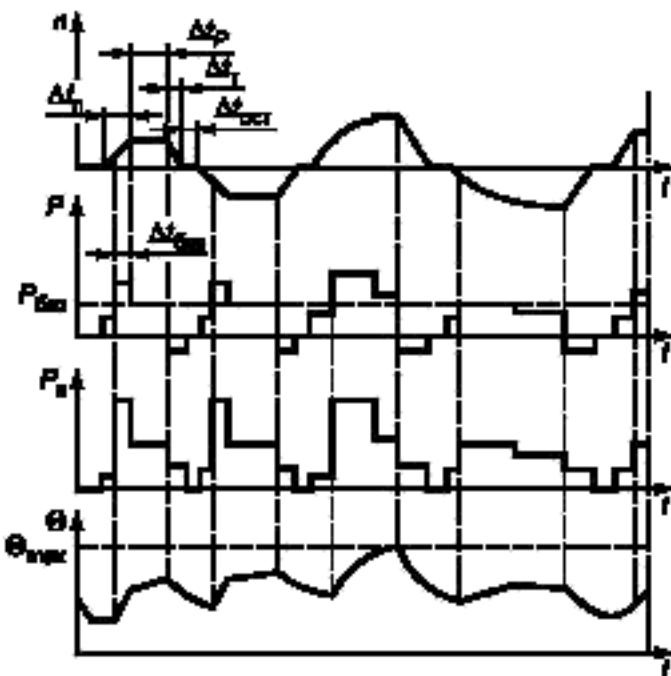
$P$  — нагрузка;  $P_{баз}$  — базовая нагрузка;  $P_s$  — электрические потери;  $\Theta$  — температура,  $\Theta_{max}$  — достигнутая максимальная температура;  $t$  — время;  $\Delta t_p$  — время работы с постоянной нагрузкой;  $\Delta t_n$  — время пуска (разгона);  $\Delta t_t$  — время электрического торможения;  $\Delta t_{ост}$  — время остановки или отключения питания машины;  $\Delta t_{баз}$  — время работы с базовой нагрузкой;  $n$  — частота вращения
