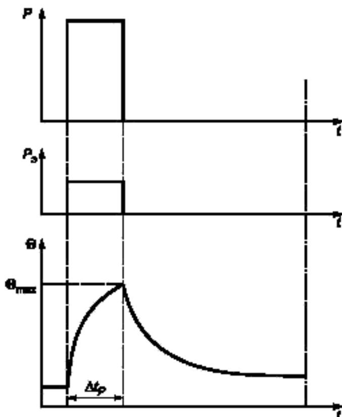
$P$  — нагрузка;  $P_d$  — электрические потери;  $\Theta$  — температура;  $\Theta_{\max}$  — достигнутая максимальная температура;  $t$  — время.  $\Delta t_P$  — время работы с постоянной нагрузкой
