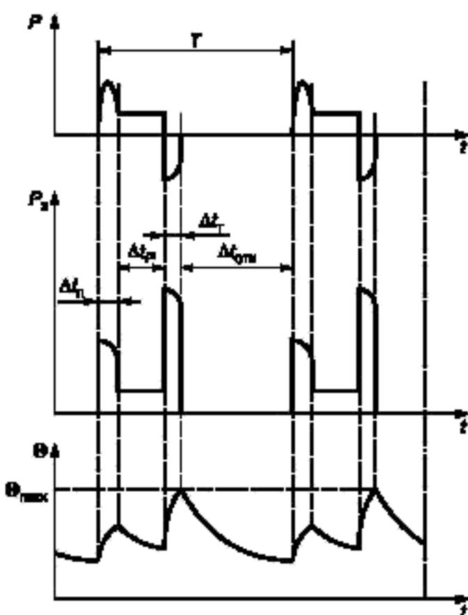
$P$  — нагрузка;  $P_x$  — электрические потери;  $\Theta$  — температура;  $\Theta_{\text{max}}$  — достигнутая максимальная температура;  $t$  — время;  $\Delta t_p$  — время работы с постоянной нагрузкой;  $T$  — время одного цикла нагрузки;  $\Delta t_{\text{отк}}$  — время остановки или отключения питания машины;  $\Delta t_n$  — время пуска (разгона);  $\Delta t_t$  — время электрического торможения
