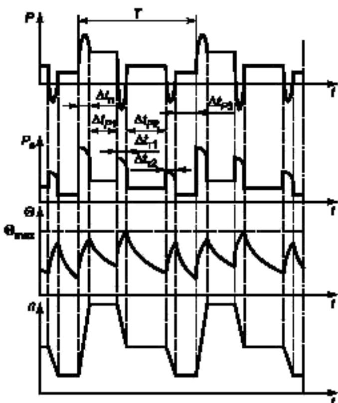
$P$  — нагрузка;  $P_2$  — электрические потери,  $\Theta$  — температура;  $\Theta_{\max}$  — достигнутая максимальная температура;  $t$  — время;  $\Delta t_p$  — время работы с постоянной нагрузкой ( $P_1, P_2, P_3$ );  $T$  — время одного цикла нагрузки ( $T_1-T_2$ );  $\Delta t_n$  — время пуска (разгона),  $\Delta t_{n1}, \Delta t_{n2}, \dots$  — время электрического торможения  $n$  — частота вращения
