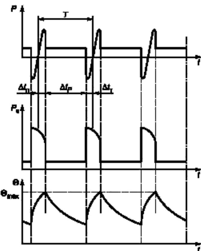
$P$  — нагрузка;  $P_d$  — электрические потери;  $\Theta$  — температура;  $\Theta_{\max}$  — достигнутая максимальная температура;  $t$  — время;  $\Delta t_P$  — время работы с постоянной нагрузкой;  $T$  — время одного цикла нагрузки;  $\Delta t_1$  — время пуска (разгона);  $\Delta t_2$  — время электрического торможения.
