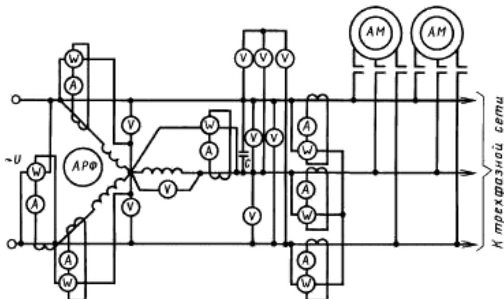
*APФ — асинхронный расщепитель фаз; AM — асинхронный двигатель*
