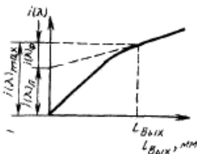
$i(\lambda)_A$  — доля фототока преобразователя излучения, обусловленная излучением линии;  $i(\lambda)_B$  — доля фототока преобразователя излучения, обусловленная излучением фона в месте излучения линии при ширине выходной щели  $l_{\text{вых}}$ .
