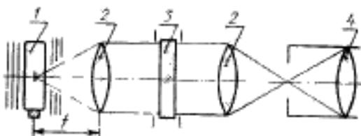
1 — источник излучения; 2 — конденсоры; 3 — нейтральный светофильтр; 4 — входной коллиматор монохроматора;  $f$  — фокусное расстояние
