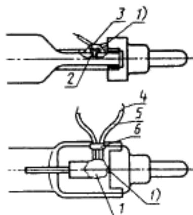
1 — цемент; 2 — припой (горячий стык); 3 — анкерная пластинка; 4 — провод термопары;
