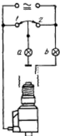
Когда выключатель находится в положении 1 и калибр полностью ввинчен в патрон, лампы *a* и *b* должны гореть. Затем выключатель переводят в положение 2 и щуп калибра доводят до упора в корпус патрона, при этом не должно быть замыкания цепи и лампы не должны гореть.
