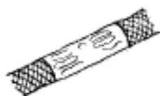
Электрические соединения обжимного типа
