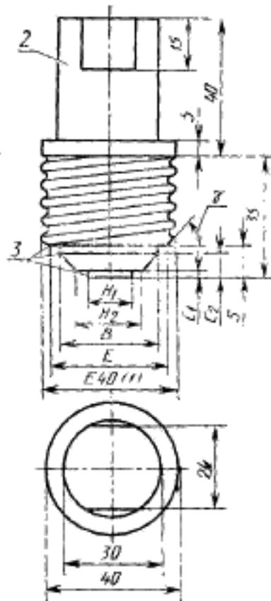
1 — сплошная жёлтая; 2 — сплошная сталь; 3 — острые кромки пригнути
