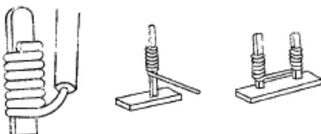
Электрические соединения с фиксацией провода
