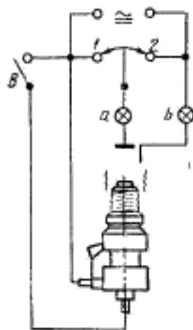
Когда выключатель *A* находится в положении 2, а выключатель *B* — в положении «отключено», калибр винтивают до того момента, когда лампа *a* или *b* загорится.
