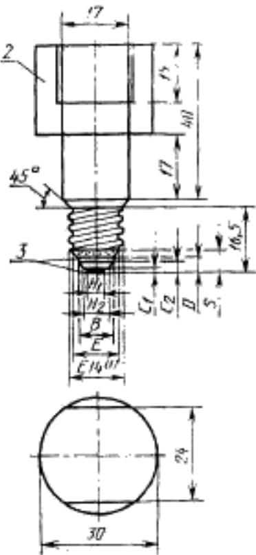
1 — сварочная медь; 2 — сплошная сталь; 3 — острые кромки пригнуть
