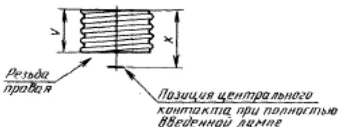
Резьбовая часть патрона должна быть расположена с учетом размера  $X$  при полностью ввернутой лампе.
