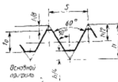
За основной профиль принимают профиль, имеющий предельные отклонения внутренней и наружной резьбы.
