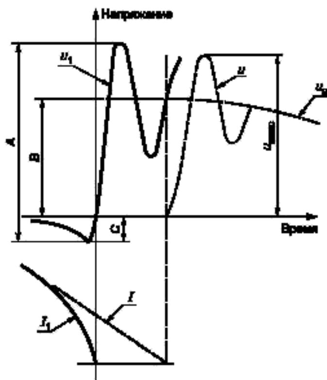
$U_1, I_1$  — напряжение и ток в опыте;  $U, I$  — собственное ПВН и ожидаемый ток;  $U_s$  — возвращающееся напряжение
