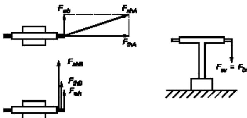
$F_{shA}$  — горизонтальная сила тяжения проводов (направление А);  $F_{shB}$  — горизонтальная сила тяжения проводов (направление В);  $F_{shC}$  — вертикальная сила тяжения проводов (направление С);  $F_w$  — горизонтальная сила давления ветра на выключатель, покрытый льдом;  $F_{shA}$ ,  $F_{shB}$ ,  $F_w$  — нормированная статическая нагрузка на выводы (результатирующие силы)
