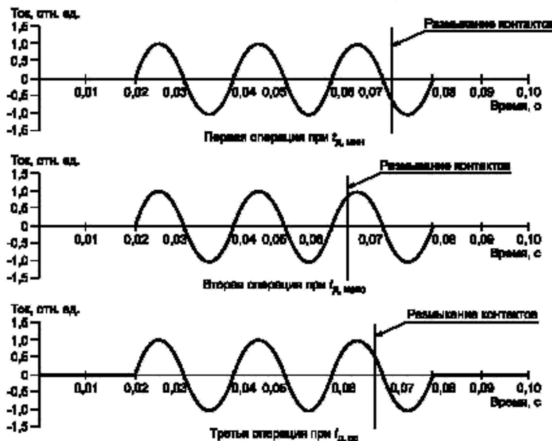
Рисунок 13 — Регулирование момента размыкания контактов относительно фазы тока при однополюсном отключении симметричного тока в режимах T10, T30, T60, T100S, Tcr1, Tcr2, Tcr3, OP2, L90, L75, L60 выключателями с  $U_{\text{ном}} \geq 110$  кВ
