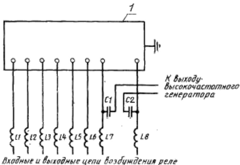
1—корпус реле;  $C1=C2=0,5 \text{ мкФ}$ ;  $L1=L2=L3=L4=L5=L6=L7=L8=1-5 \text{ мГц}$
