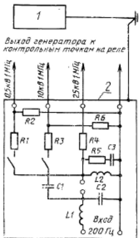
1—корпус реле; 2—корпус генератора  $L_1=26$  Гн;  $L_2=6,3$  мкГн;  $C_1=20$  нФ;  $C_2=4$  нФ;  $C_3=8$  нФ;  $R_1=1000$  Ом;  $R_2=250$  Ом;  $R_3=500$  Ом;  $R_4=200$  Ом;  $R_5=100$  Ом;  $R_6=2500$  Ом
