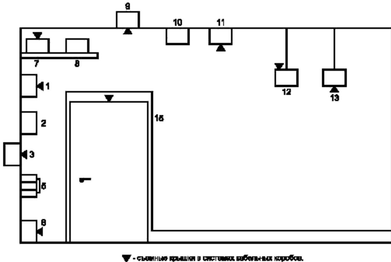
Рисунок 101 — Типы и способы установки систем кабельных и специальных кабельных коробов, предназначенных для установки на стенах и потолках
