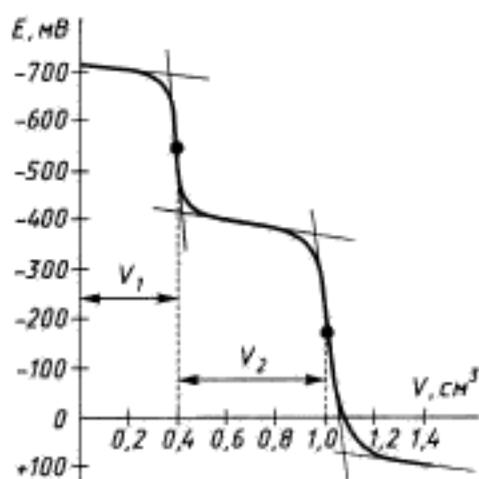
Рисунок 1 — Кривая титрования смеси сероводорода и меркаптанов
