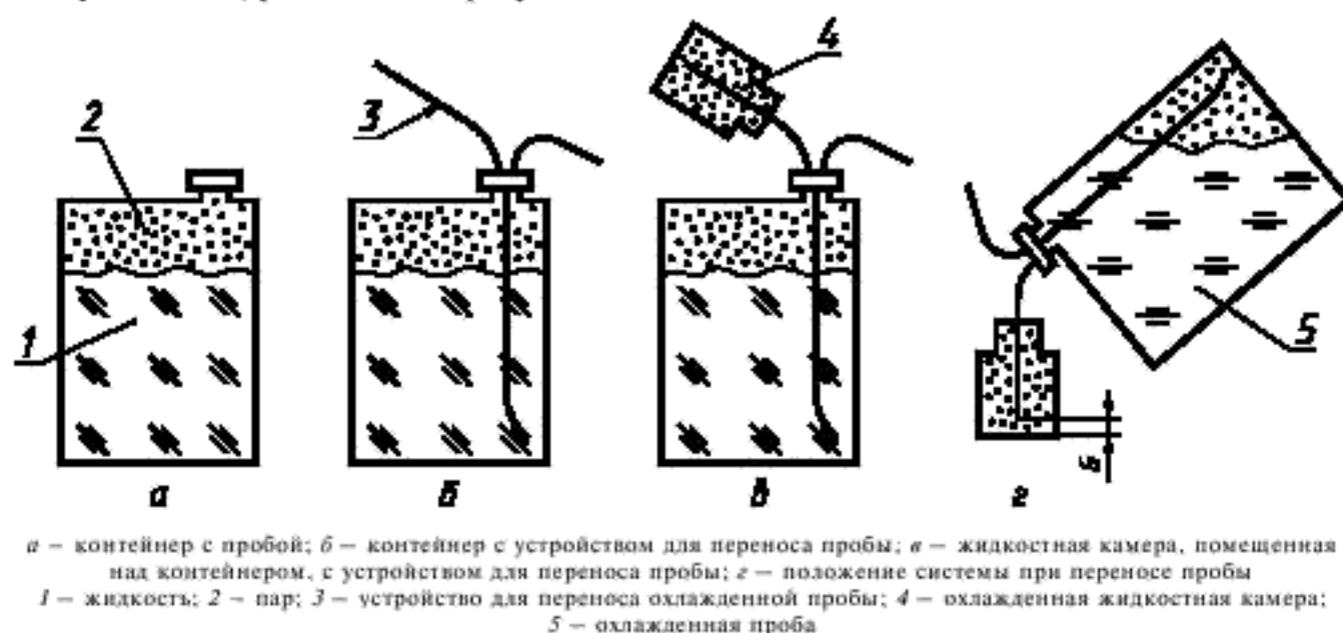
а – контейнер с пробой; б – контейнер с устройством для переноса пробы; в – жидкостная камера, помещенная над контейнером, с устройством для переноса пробы; г – положение системы при переносе пробы
