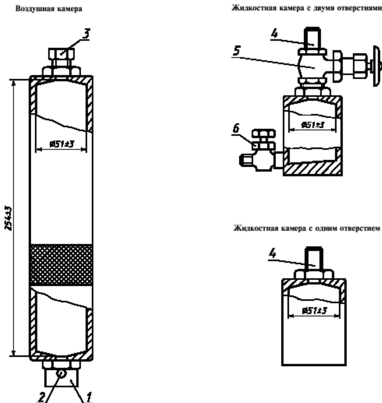
1 — присоединительный внутренний диаметр 13 мм; 2 — вентиляционное отверстие; 3 — присоединительный внутренний диаметр 5 мм; 4 — присоединительный внешний диаметр 13 мм; 5 — клапан 13 мм; 6 — клапан 6 мм
