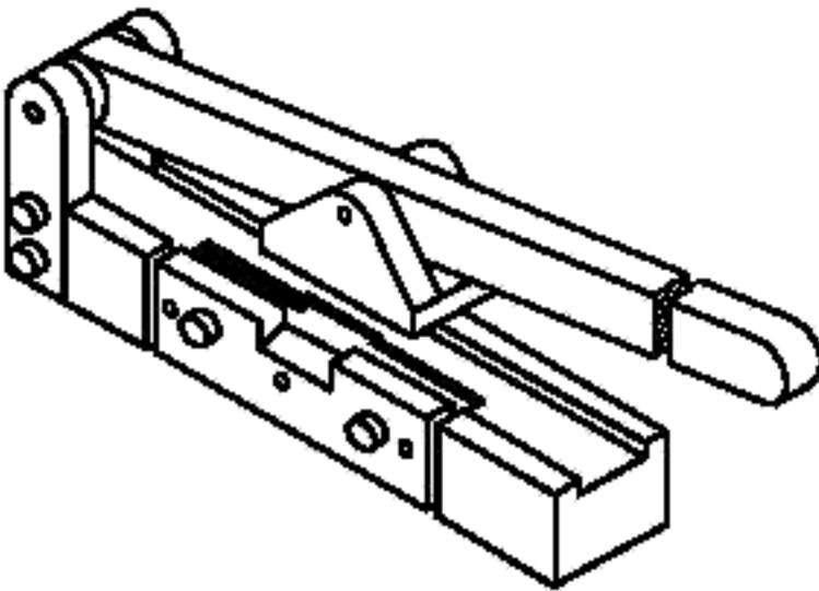
Рисунок 1 — Приспособление для нанесения надрезов в образцах
